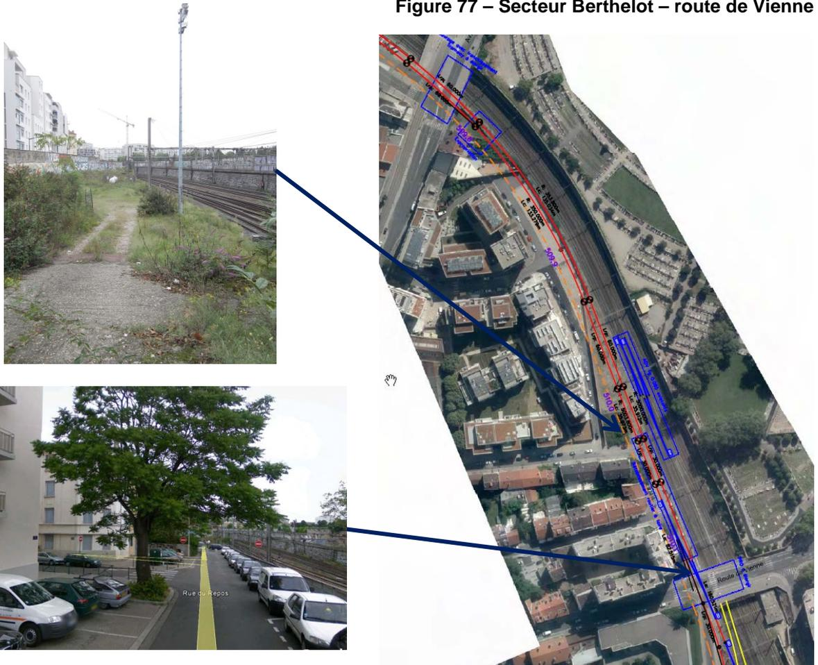
Les méthodes envisagées sur ce secteur sont similaires aux secteurs précédents, toutefois la proximité du bâti imposera des contraintes spécifiques sur le soutènement qui devra limiter le plus possible les tassements. Une couverture est envisagée au-dessus des voies ferrées pour permettre la réalisation d'une voirie (maintien de la réservation foncière actuelle). Cette couverture s'appuiera sur le soutènement et des appuis réalisés entre les voies bis et les voies ter.
